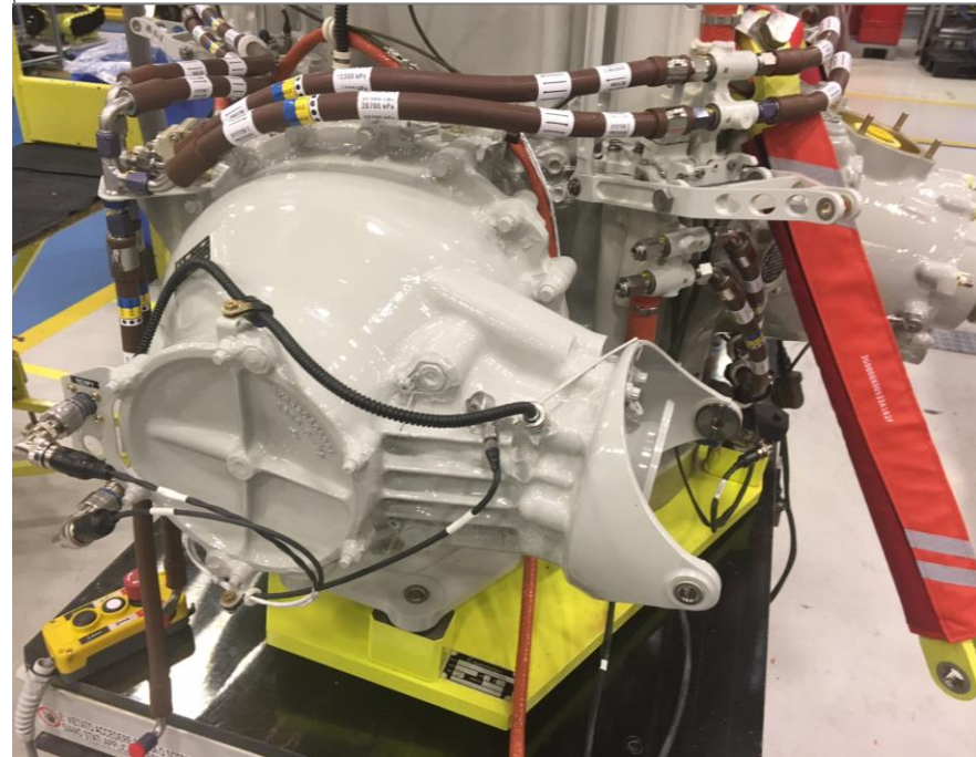
AW139 Main Gearbox Input Module (Kawasaki)
